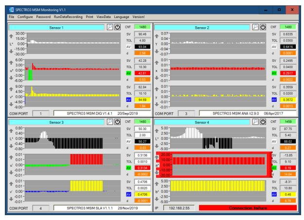
Die im **OUTPUT FILE CONFIGURATION PANEL** ausgewählten Daten, sowie die jeweiligen **d** Werte werden sofort in der entsprechend angelegten Datei abgespeichert, falls dies aktiviert ist. Die Gesamtanzahl der aufgezeichneten Werte findet man im Display **CNT**.
