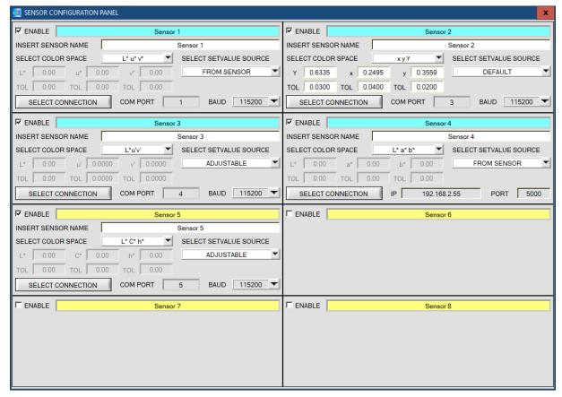
Damit von einem Sensor Daten aufgezeichnet werden können, muss dieser mit "**ENABLE"** aktiviert werden. Unter "**INSERT SENSOR NAME"** definiert man einen Namen für den Sensor. Dieser Name wird dann im Hauptfenster angezeigt, im Ausgabefile abgespeichert und ebenso ausgedruckt.
